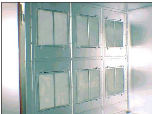
全面の吸込み口と耐熱フィルター (オプション)による防塵対策。
